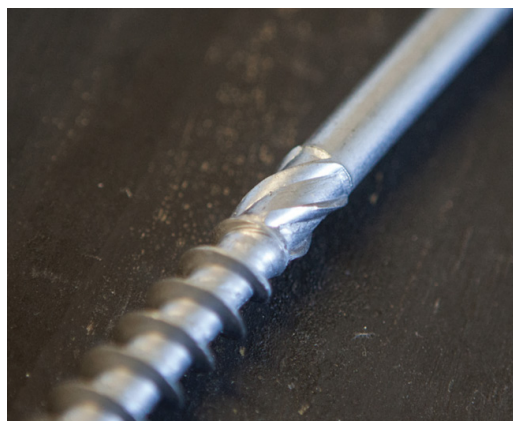
Fræseribben reducerer indskruningsmomentet.
