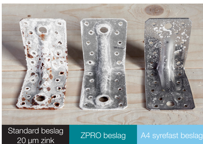
Billede: Resultat af cyklisk salttågetest - Normalt udendørs miljø - Tid: ca 14.000h (C3 = 12.000h-13.000h = ca. 15 år)
